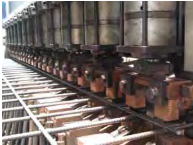
Machine à souder les panneaux.
